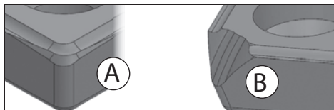
Fig. A: uzura normala: rotiti / inlocuiti cutitele reversibile.
