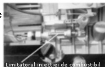
Limitatorul injectiei de combustibil
