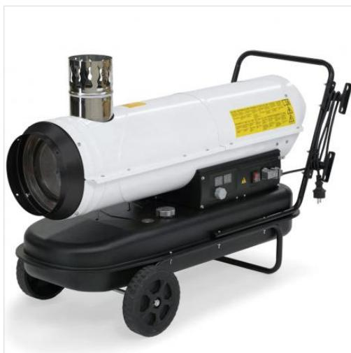
**CARACTERISTICI TEHNICE**Putere calorica (kW): **30**Putere calorica (kcal/h): **-**Consum carburant ( l/h ): **2.8**Debit de aer ( m3/h ): **780**Capacitate rezervor l: **50**Putere motor electric W: **250**Tensiune de alimentare ( V ): **230**Frecventa ( Hz ): **50**Diametru cos evacuare gaze ( mm ): **120**Combustibil: **motorina**Diametru evacuare aer cald ( mm ): **300**Dimensiuni ( mm ): **1107 x 498 x 766 mm**Greutate ( Kg ): **34****DESCRIERE PRODUS**
